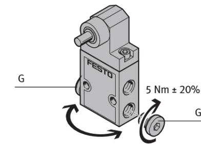
Die Verschlusschraube (G) kann wahlweise links oder rechts in Anschluss 2 eingedreht werden.
